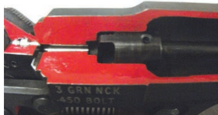
КРУПНЫЙ ПЛАН ОЧИСТИТЕЛЯ ЗАТВОРА В СБОРКЕ: ЧИСТЯЩАЯ ГОЛОВКА В ОТВЕРСТИИ ПОРШНЯ
